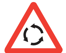
Intersección con circulación giratoria
